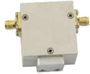
**示例:** 6466H 系列同轴隔离器, 30~40MHz, 正向功率 30W, 反向功率 20W, SMA 母头, 顺时针, 型号: QCI6466H-30-40-30-20-S-1
