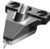
**示例：**探针，DC~40GHz，GSG，间距 100μm，触点大小 50μm，45°，镀铜，型号：
