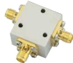
**示例：**6466H 系列同轴环行器，55-75MHz，100W，N 母头，顺时针，型号：QCC6466H-55-75-K1-N-1。
